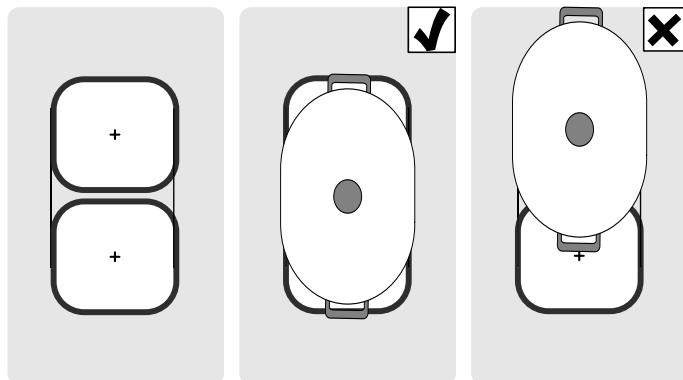
Если на одной из двух зон нагрева вы используете только один предмет посуды, его можно передвинуть на вторую зону нагрева. В этом случае уровень мощности и выбранные установки будут приняты.
