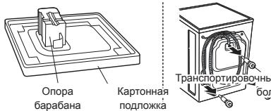
Снимите транспортировочные болты и опоры.
